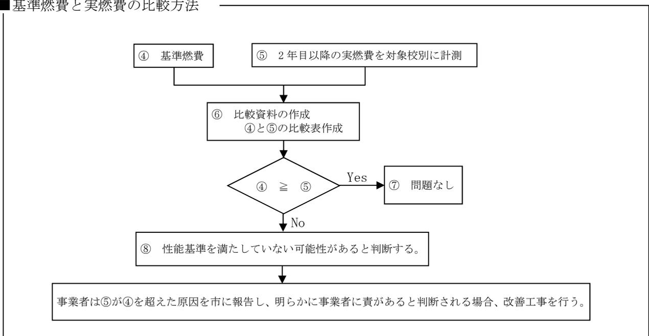
電力を主なエネルギー(EHP)とする場合は、電気消費量を対象とし、ガスを主なエネルギー(GHP)とする場合は、ガス消費量を対象として比較を行う。同一校において、EHPとGHPが混在している場合には、それぞれ比較を行う。
